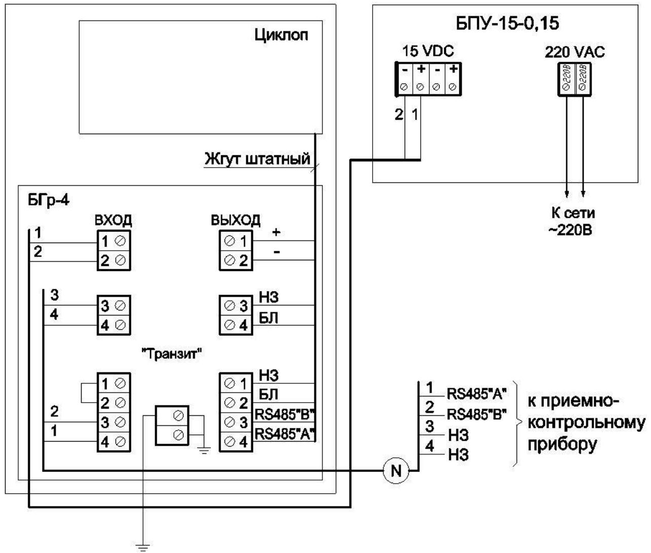
**Рисунок 9.1 – Схема подключения извещателя**
